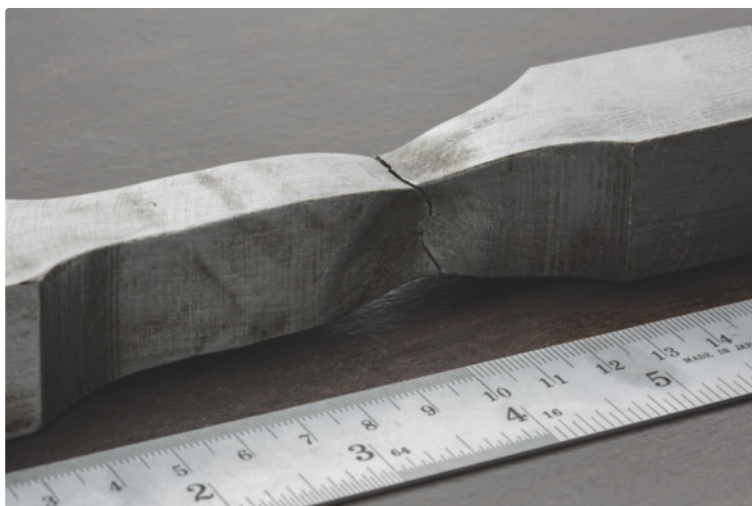
Figuur 19 Opmeten van de breekrek (Bron: Shutterstock / Kimtaro)
