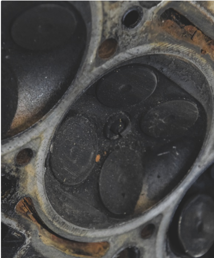
Figuur 12 Verbrande klep (Bron: Shutterstock / eleonimages)
