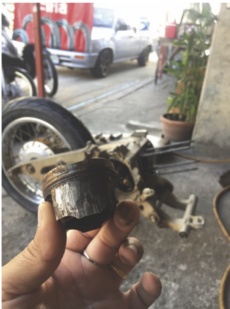
Figuur 13 Problemen met glij-eigenschappen van aluminium (Bron: Shutterstock / GolfStandard)
