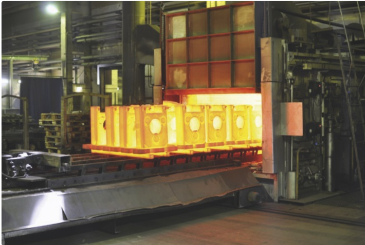
Figuur 24 Gloeien in een kameroven (Bron: Shutterstock / industryviews)
