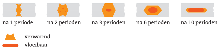
Figuur 6 Warmteontwikkeling in de puntlas
