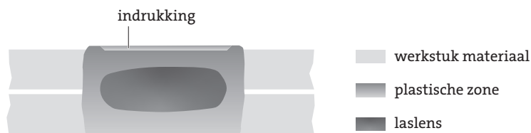
Figuur 4 Vorm en structuur van een laslens
