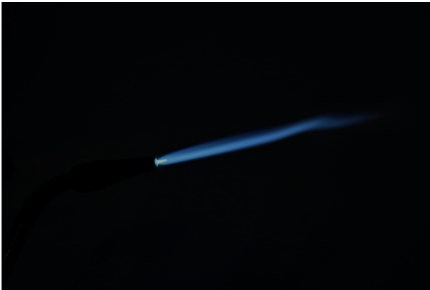
Figuur 5 Oxiderende vlam
