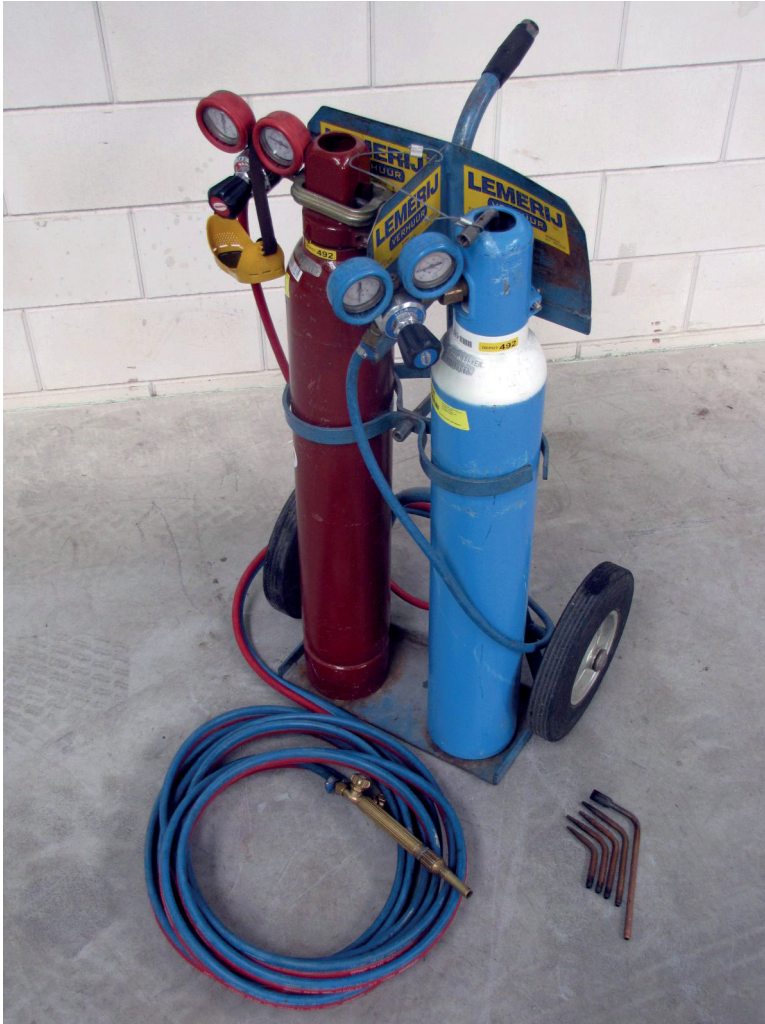
Figuur 14 Mobiele autogene lasinstallatie
