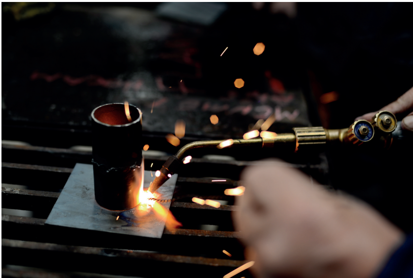
Figuur 2 Autogeen lassen van een buis
