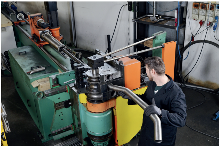
Figuur 6 CNC-pijpbuigmachine met doorn
