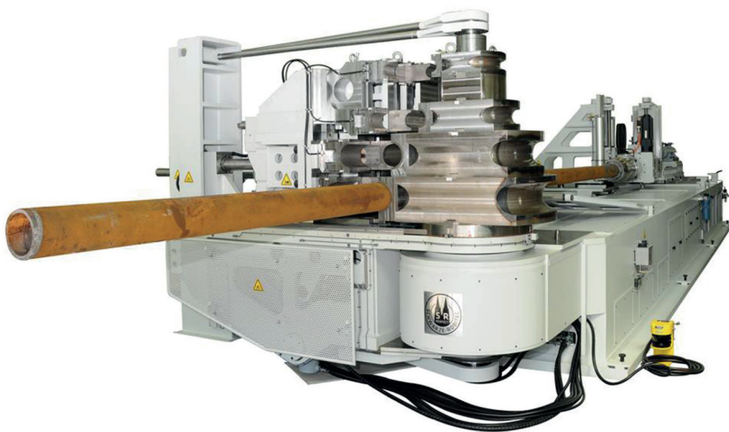
Figuur 15 Uitstekend pijpdeel bij CNC-pijpbuigmachine
