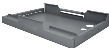
Figuur 22 Product gemaakt op een CNC-strijkbuigmachine
