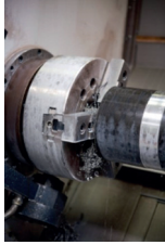
Figuur 12 Ringvormig product opgespannen in drieklauw
