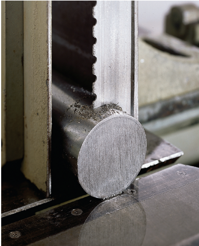
Figuur 27 Bandzaag met diamantgrit op verticale machine
