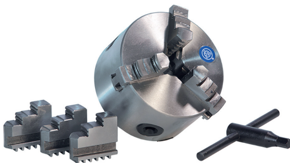
Figuur 13 In- en uitwendig spannen in een drieklauwplaat
