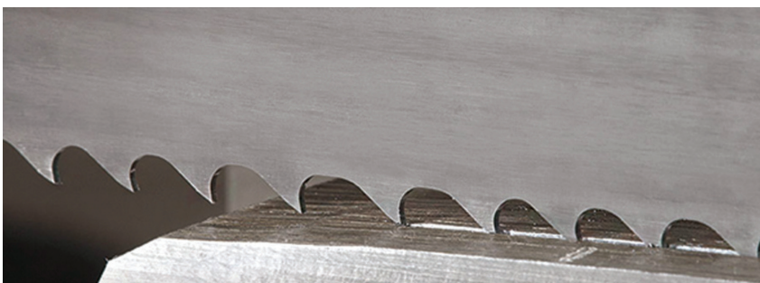
Figuur 26 Bandzaag van bimetaal
