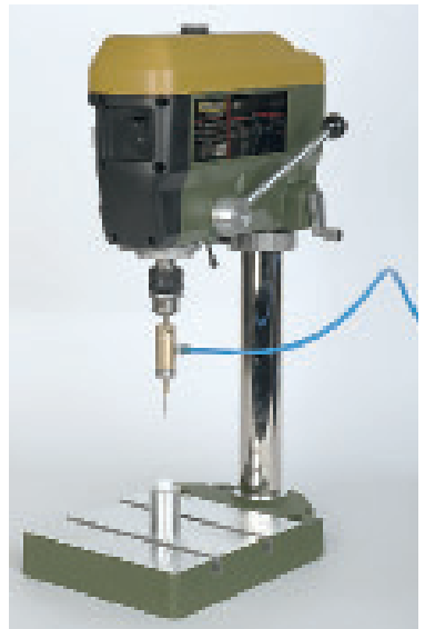
Elektrisch aangedreven boor. Door de holle boor wordt de koelvloeistof aangevoerd.
