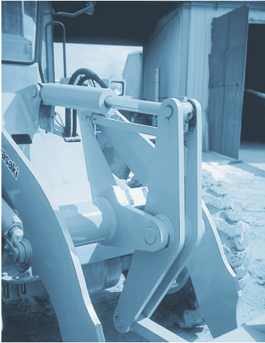
Veel machine-elementen worden met pennen met elkaar verbonden, zodat ze in de verbindingen vrij kunnen draaien. Deze ondersteuning oefenen wel een kracht uit op de machine-elementen, maar geen moment.
