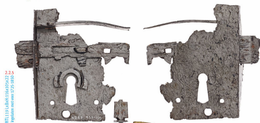
2.2.5 Schootgrendelslot met schootsluiting (ijzer) 1725-1900 \Sigma=6(3)
